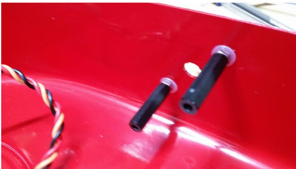
Assicurare il sensore con due bulloni M2,5 utilizzando due rondelle per ciascun bullone, una per ciascuna faccia della PCB.
