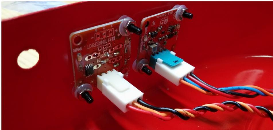
Sul lato sinistro del guscio alloggerà il sensore di gas. Posizionare nei due fori esterni due bulloni M2,5 e inserire dal lato interno in ordine: rondella M2,5 in poliamide, dado M2,5 in acciaio e distanziale M2,5 da 20mm.
