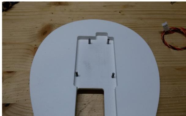
Alloggiare l'Arduino YUN e serrare i due bulloni superiori e quello inferiore di destra tramite i dadi M3 in poliamide. Bloccare il rimanente bullone con un punto di colla a caldo.
