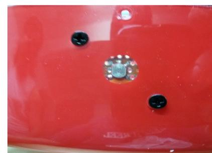
Ripetere la stessa operazione di montaggio con i sensori di temperatura e pressione sul lato destro (visto dall'esterno) del guscio.
